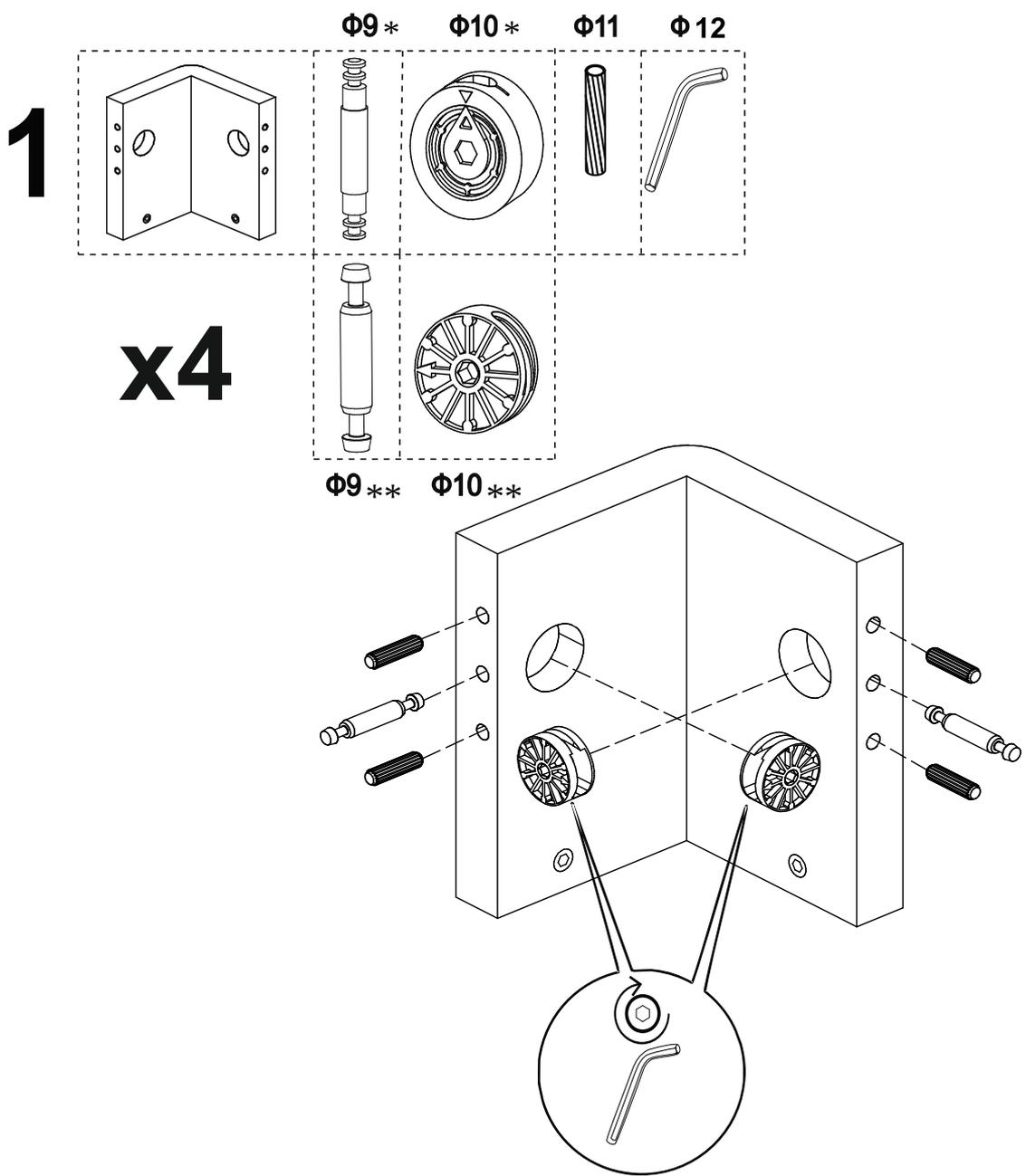
Перед установкой эксцентрика комплектации «\*» проверить и совместить стрелку на пластиковом корпусе и металлической части эксцентрика
